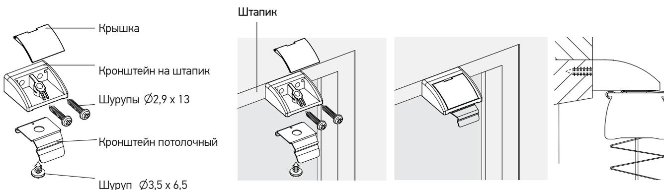
При наличии подоконных кронштейнов устанавливается пара кронштейнов на штапик для фиксатора (правый и левый), для моделей P1615 и P2615 устанавливаются две пары. Каждый кронштейн крепится в углу штапика одним шурупом  $\varnothing 2,9 \times 9,5$  и одним  $\varnothing 2,9 \times 13$ .
